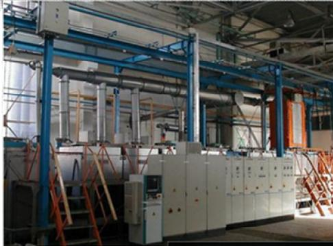
Автоматическая линия солевых ванн для упрочнения серийных деталей
